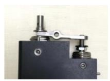
THERE IS <u>ONE</u> WASHER ON THE SHUTOFF CYLINDER <u>BELOW</u> THE LEVER
